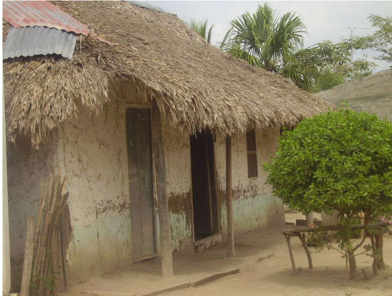
Vivienda típica de la zona (techo paja, paredes en bahareque y pisos en tierra)
